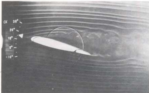
Die Umströmung des Tragflügelprofils bei verschiedenen Anstellwinkeln, Endklappen eingefahren.
